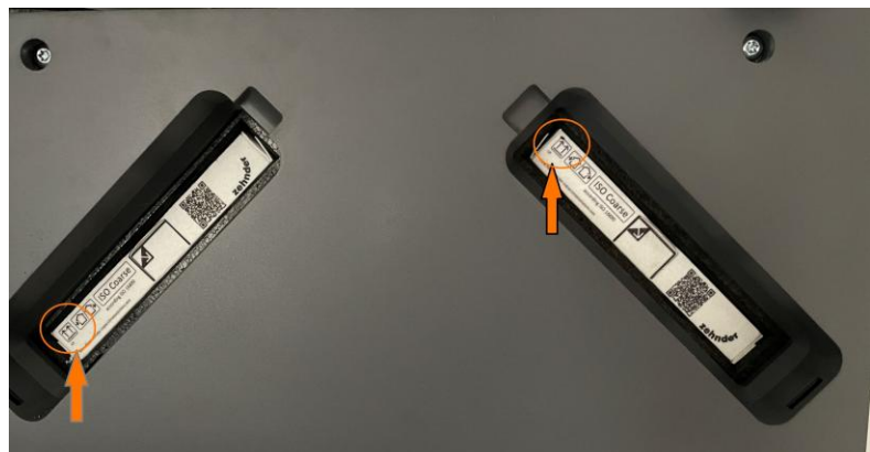
Figuur 5; filters met peil naar boven in de unit schuiven
